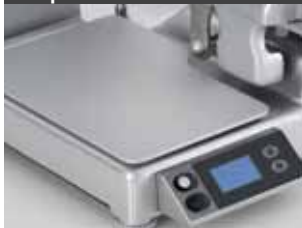
Applicazione bilancia: Pesata max Kg 10 - precisione gr. 2 piatto smontabile mm 225x360
